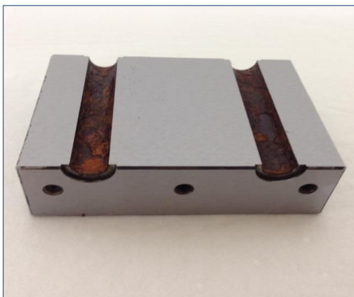
洗浄前の冷却管断面
